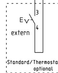
Ist ein externer Betriebsartenschalter angeklemt und der Dip-Schalter Nr. 7 befindet sich in der Stellung ON, wird die Funktion des internen Betriebsartenschalters ausser Kraft gesetzt. Ein geschlossenen Schalter signalisiert die Betriebsart Thermostat optional (Thermostat oder Zeitschaltuhr an Klemme 32/33 angeschlossen).
