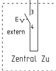
Bei geschlossenem Schalter werden alle Gruppen unabhängig von den Lüftungstastern und dem Thermostat zugefahren !!
