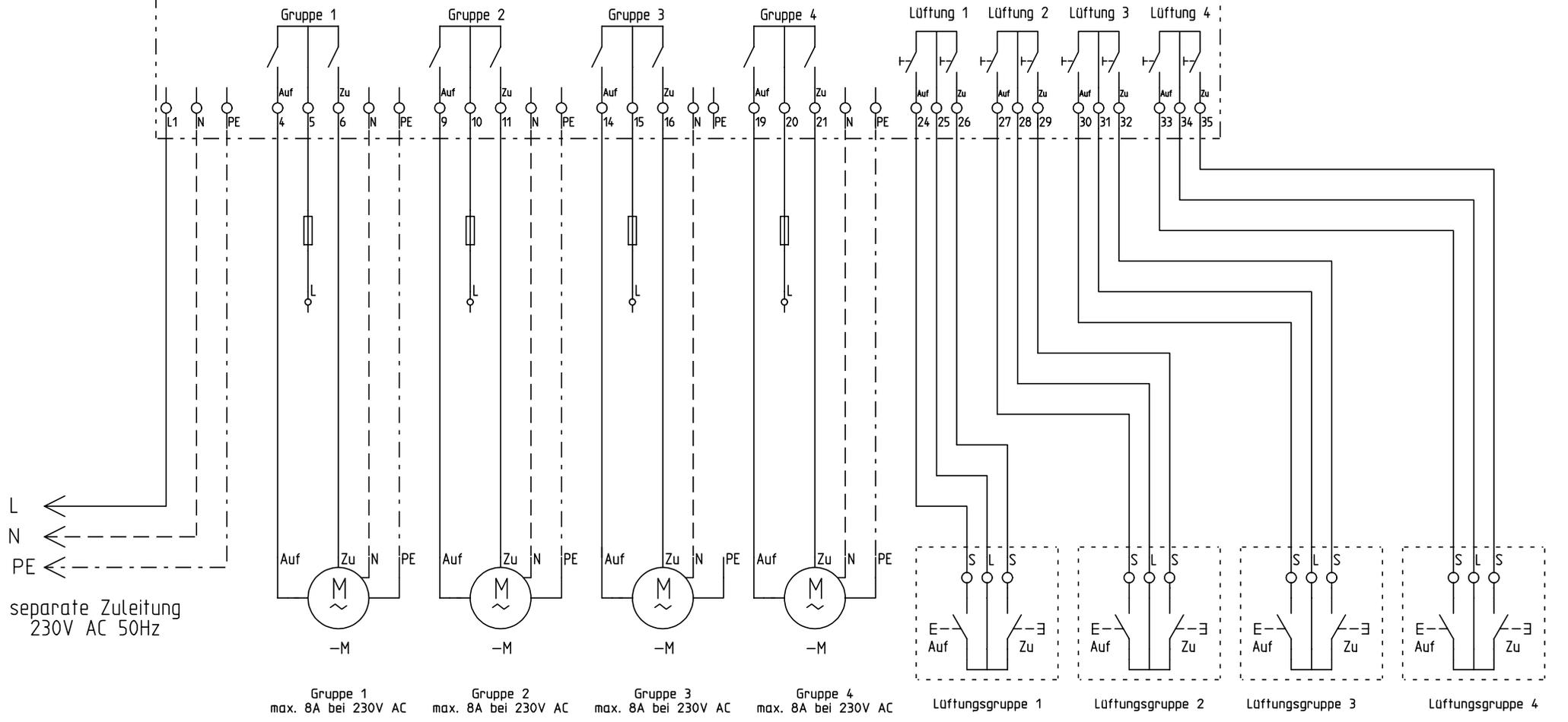
Alle Vier Gruppen können max. mit 230V AC / 8A belastet werden. Eine Absicherung der einzelnen Gruppen muss vor Ort vorgenommen werden. Die Potentiale N und PE sind auf der Steuereinheit durchverbunden.
